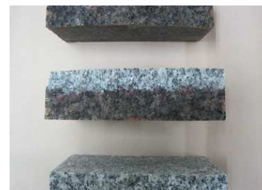
浸透層の確認。白い部分が浸透層。
