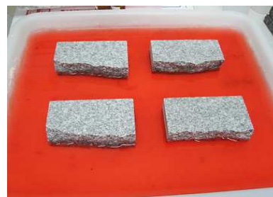
吸上げ試験の状態。
